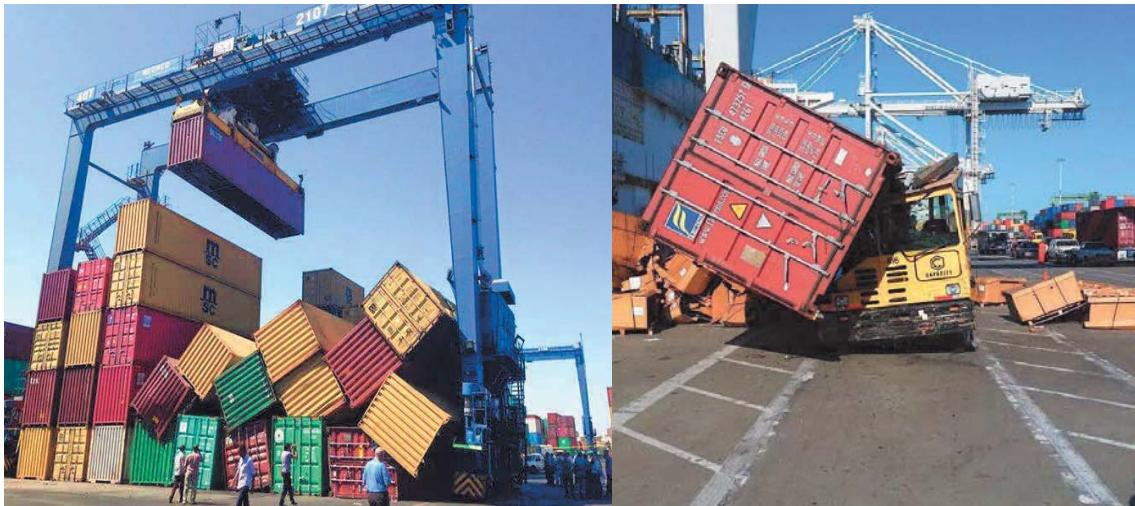
El Comité de Seguridad de la ILA~USMX ha observado que a nivel mundial ha habido un incremento en la incidencia de contenedores almacenados en estibas que son golpeados y derribados fuera de su posición por otro contenedor siendo movido por una grúa a través de la cubierta del barco, especialmente con grúas del tipo puente o “rubber tire gantry” (RTGs).
